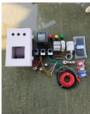
ภาพที่ 7 แสดงออกแบบสร้างและจัดเตรียมวัสดุ อุปกรณ์ ชุดตรวจวัดคุณภาพไฟฟ้า
