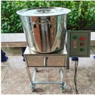
(ค) การลดน้ำมันในกล้วยฉาบด้วยเครื่องเหวี่ยงสลัดน้ำมันที่ออกแบบและสร้างขึ้น
