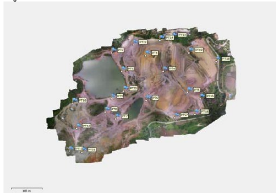
รูปที่ 1 การนำเข้าสู่ข้อมูลของหมุดที่ได้จากเครื่องรับสัญญาณดาวเทียม
