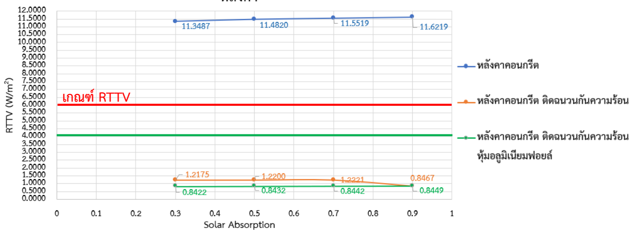
รูปที่ 10 ผลการเปรียบเทียบค่า RTTV ของหลังคาทั้ง 3 ชนิด
