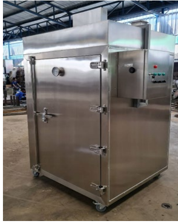
รูปที่ 3 เครื่องอบแห้งเส้นใยกล้วย
