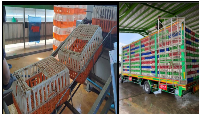
รูปที่ 19 วิธีการล้างกล่องจับไก่แบบกลมแบบใช้เครื่องล้าง
