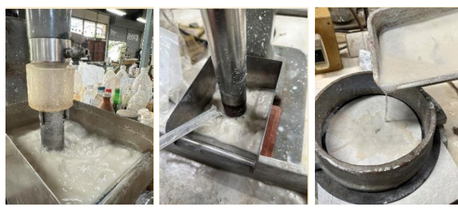
รูปที่ 2 เม็ดแร่ลพิษที่เกาะฟองอากาศลอยขึ้นมา
