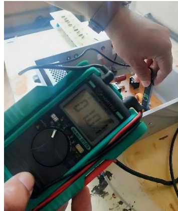
รูปที่ 6 วัดค่ากระแสที่ใช้ในวงจรโดยแอมป์มิเตอร์
