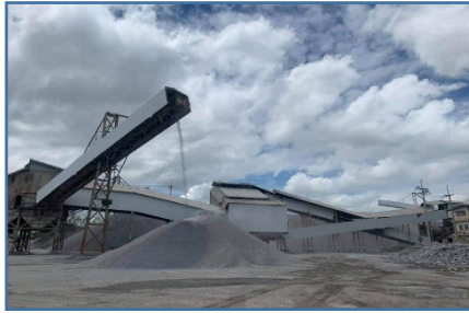
รูปที่ 1 โรงโม่หินบริษัท ปราจีนบุรี เหมืองหิน จำกัด และ วัสดุหินฝุ่น
