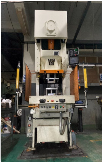
รูปที่ 6 เครื่องเพรสแมคคานิกส์ ยี่ห้อ AIDA
