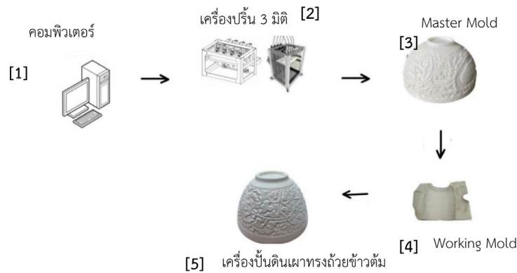
รูปที่ 5 แนวคิดในการปรับปรุงกระบวนการด้วยเครื่องปั้น 3 มิติ
