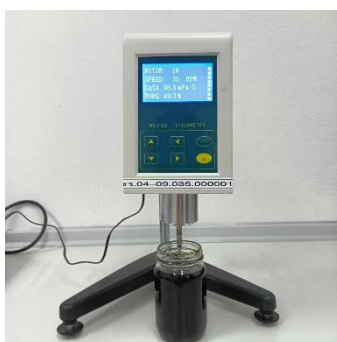
(ก) ลักษณะกายภาพน้ำมันหล่อลื่นใช้แล้ว (ข) การวัดค่าความหนืด (ค) การตรวจวัดการเผาไหม้
