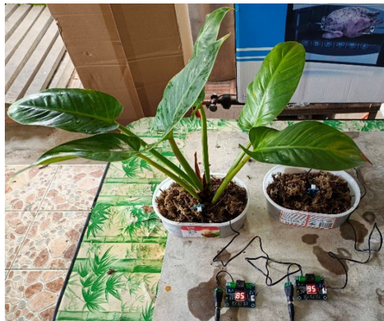
ภาพที่ 1 แสดงการจัดตั้งระบบวัดการเปลี่ยนแปลงความชื้นแบบเปรียบเทียบ
