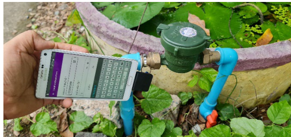
รูปที่ 3.4 การใช้สมาร์ทโฟนอ่านข้อมูล RFID จาก RFID Tag
