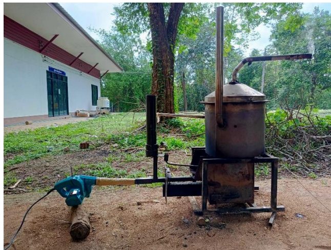
(ข) เตาปฏิกรณ์ไพโรไลซิสและระบบการเผาไหม้ รูปที่ 2 อุปกรณ์ผลิตไบโอชาร์ด้ายน้ำมันหล่อลื่นใช้แล้ว
