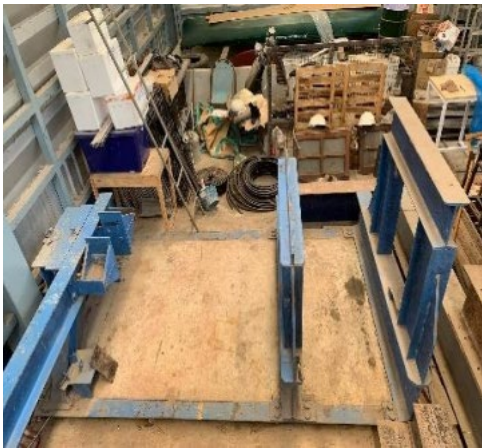
(ก) เครื่องมือทดสอบรับแรงบิด
