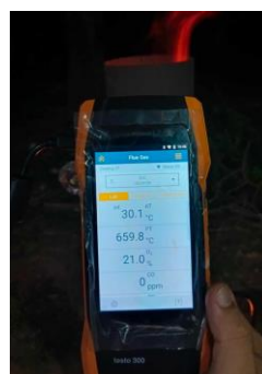
(ก) ลักษณะกายภาพน้ำมันหล่อลื่นใช้แล้ว (ข) การวัดค่าความหนืด (ค) การตรวจวัดการเผาไหม้
