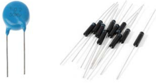
รูปที่ 2 (ก) ตัวเก็บประจุและไดโอด (ข) วงจรทวีแรงดัน
