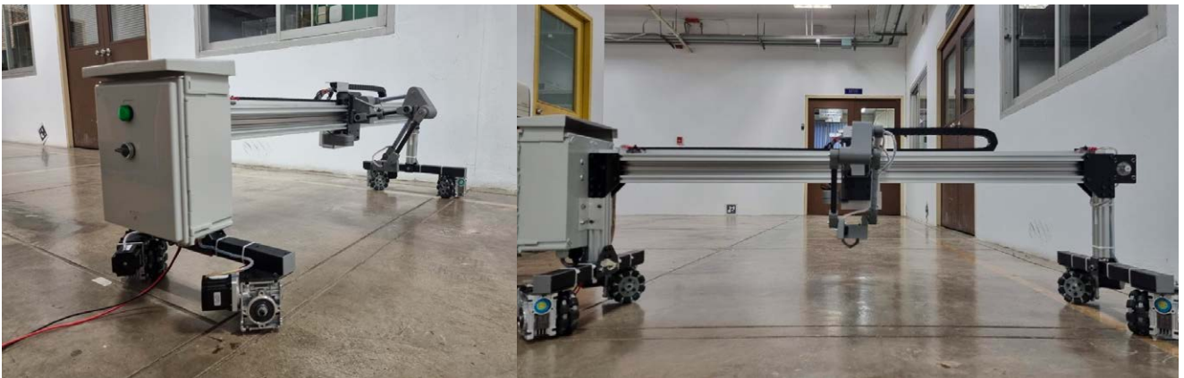
ภาพต้นแบบหุ่นยนต์ กำจัดวัชพืชที่สร้างขึ้น โดยใช้โครงสร้างอะลูมิเนียม เหล็กกล่อง เหล็กพับ และพลาสติกขึ้นรูป ด้วยวิธี 3-D printing
