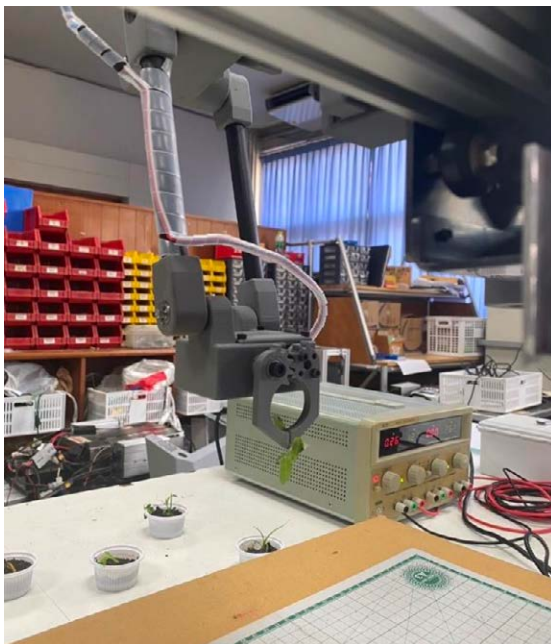
ภาพการทดสอบความแม่นยำของการเทียบตำแหน่งของวัชพืชหลังจากที่ตรวจจับวัชพืชได้
