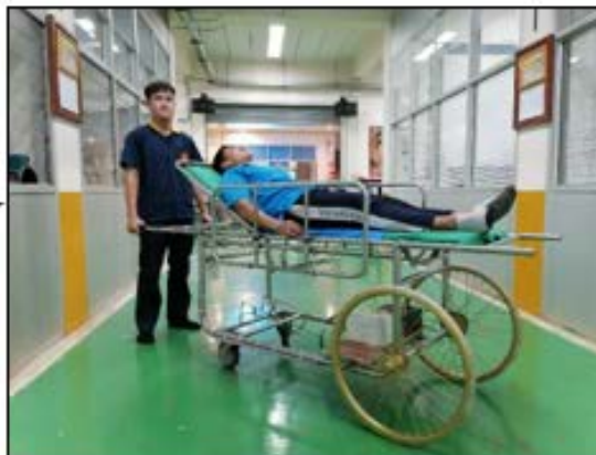
ภาพที่ 1. สิ่งประดิษฐ์รถเข็นเปลเคลื่อนย้ายผู้ป่วยกึ่งอัตโนมัติแบบควบคุมด้วยมอเตอร์ไฟฟ้า
