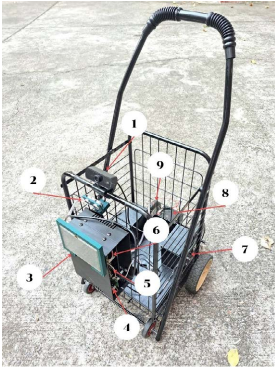
1) อุปกรณ์ควบคุม ได้แก่ 1. กล้องเว็บแคม 2. เซนเซอร์วัดระยะ 3. จอแสดงผล 4. ตัวแปลงไฟ 5. รางสเบอร์พาย 6. บอร์ดโดร์ฟมอเตอร์ 7. มอเตอร์เกียร์ 8. แบตเตอรี่ขนาด 12V9Ah 9. ล้อประกอบ
