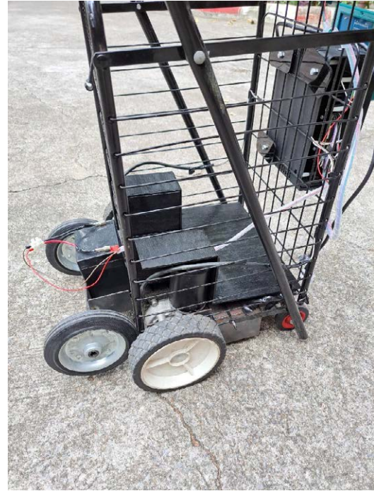
2) มอเตอร์เกียร์ (มอเตอร์ปิดน้ำฝน) จำนวนสองตัว ล้อหลังสำหรับการบังคับโดยไม่ใช้มอเตอร์
