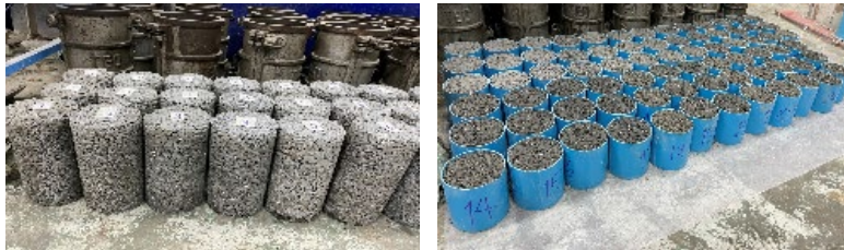
(ก) คอนกรีตพูนขนาด 100 มม. สูง 200 มม. (ข) คอนกรีตพูนขนาด 100 มม. สูง 100 มม.
