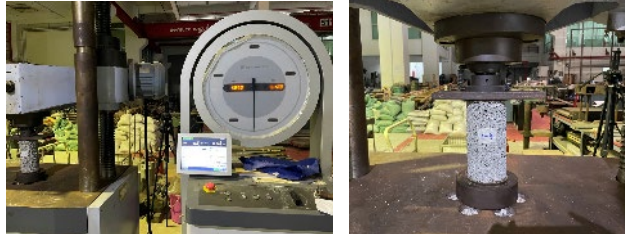
รูปที่ 5 การทดสอบกำลังรับแรงอัดของคอนกรีตพูน
