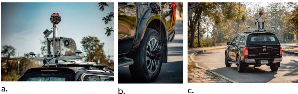
รูปที่ 3 a) ระบบ GNSS+IMU+กล้อง b) Distance Measuring Instruments c) ติดตั้งอุปกรณ์ทั้งหมดบนรถสำรวจ (สถาบันสารสนเทศทรัพยากรน้ำ, 2566)
