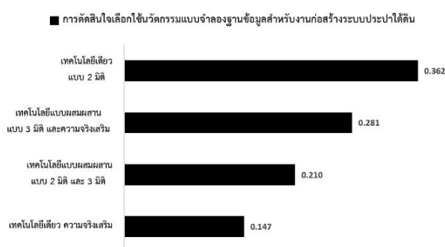
รูปที่ 4 ค่าน้ำหนักการเลือกใช้แบบจำลองฐานข้อมูลสำหรับงานก่อสร้างระบบการวางท่อประปาใต้ดิน
