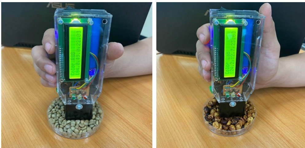
ภาพที่ 7 การวัดสีเมล็ดกาแฟจากเครื่องวัดต้นแบบ
