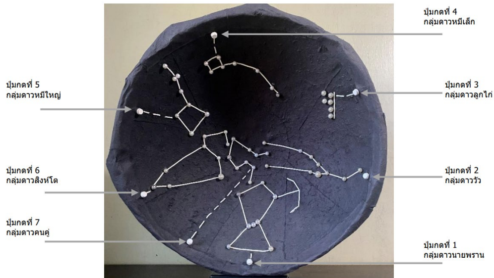
รูปที่ 9 ตำแหน่งสวิตช์ปุ่มกดทั้ง 7 กลุ่มดวงดาวบนเครื่องทอผ้าจำลองที่นำเสนอ
