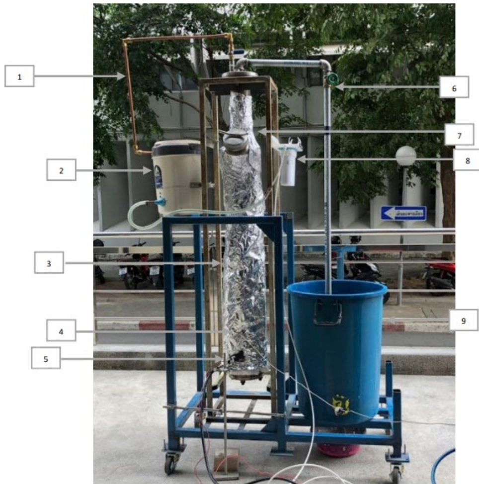
รูปที่ 3 - 1 เครื่องปฏิกรณ์พลาสมาและอุปกรณ์
