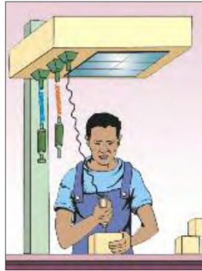
รูปที่ 7 ตัวอย่างสายห้อยสปริงค์หัวฉีดเหนือศีรษะ (The International Labour Office, 2010)
