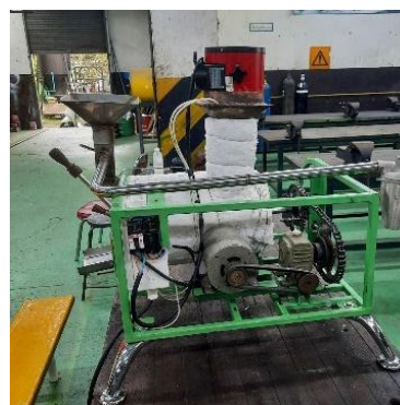
รูปที่ 1 เครื่องคั่วเมล็ดกาแฟด้วยลมร้อน ด้านหน้าและด้านข้างของเครื่องคั่ว
