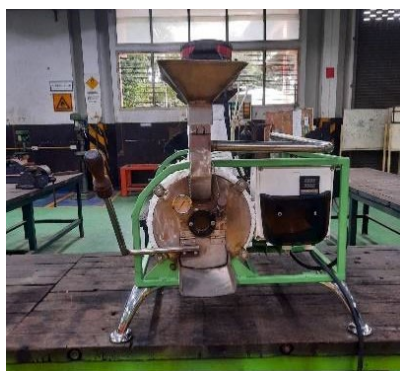
รูปที่ 1 เครื่องคั่วเมล็ดกาแฟด้วยลมร้อน ด้านหน้าและด้านข้างของเครื่องคั่ว
