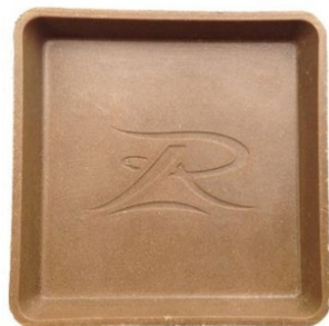
รูปที่ 6 ภาชนะจานรองต้นแบบจากวัสดุคอมโพสิตพอลิเอทิลีนความหนาแน่นต่ำชนิดโครงสร้างตรง/เส้นใยแก้ว/เปลือกไข่ ชนิดปรับปรุงพื้นผิวด้วยสารเคมีที่ส่วนผสม 60/20/20 เปอร์เซ็นต์
