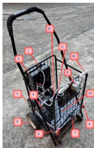
รูปที่ 4 ส่วนประกอบของหุ่นยนต์เด็กวัดควบคุมด้วยเทคนิคการประมวลผลภาพ
