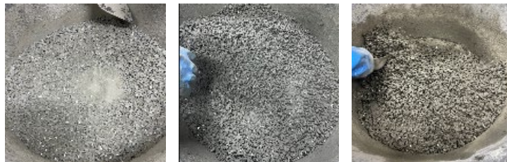
รูปที่ 3 การผสมคอนกรีตพูน
