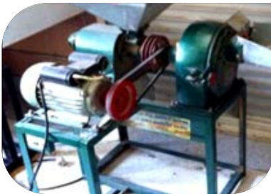
เครื่องหั่นย่อยใบไม้และกิ่งไม้แบบละเอียด
