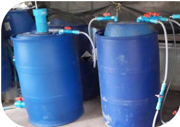
ชุดถังหมักขนาด 200 ลิตรที่มีใบพัดกวนและมีท่อต่อเข้ากับเตาฟุ้งต้มได้
