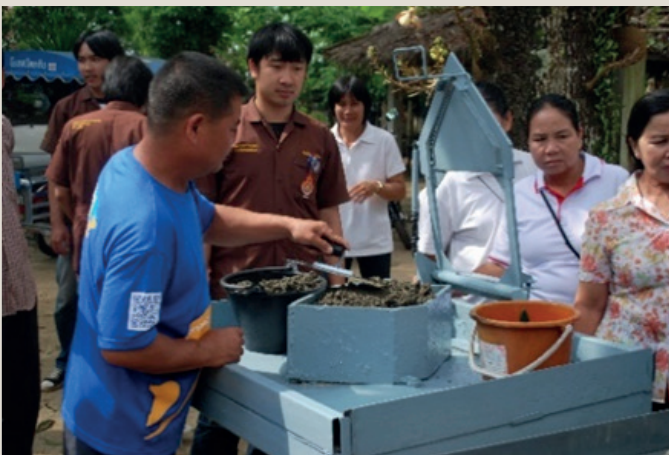
ภาพแสดง การหล่ออัดขึ้นรูปแผ่นกระเบื้องในแบบพิมพ์
