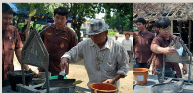
ภาพแสดง การชโลมน้ำมันบนแบบพิมพ์กระเบื้อง
