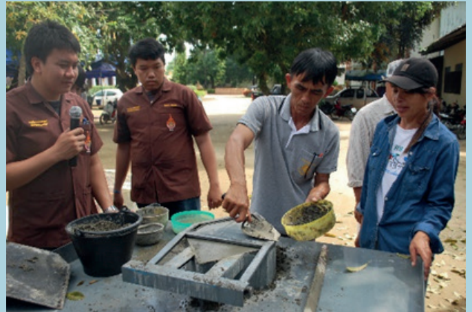
ภาพแสดง การแต่งผิวหน้าให้เรียบและขัดมันผิวหน้าแผ่นกระเบื้องด้วยปูนซีเมนต์ผง
