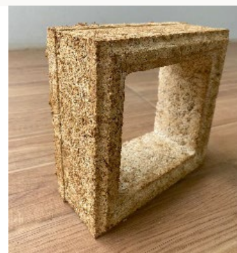
ภาพที่ 5 บล็อกช่องลมไม่รับน้ำหนักจากแกนกัญชา
