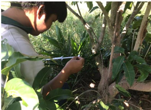
ภาพที่ 16 ทำการวัดเส้นผ่าศูนย์กลางลำต้นโดยใช้เวอร์เนียร์คาลิเปอร์
