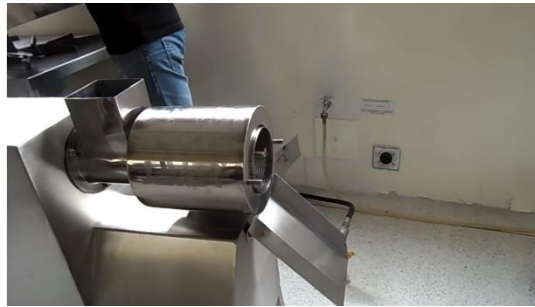
ภาพการถอดประกอบจากเครื่องแยกเนื้อเสาวรส เพื่อปรับเป็นเครื่องแยกเนื้อมะเกี๋ยงต้นแบบ
