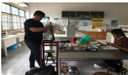
ลักษณะการผ่าเปลือกหุ้มเนื้อในเมล์ดมะกึ่ง ด้วยมีดโค้งวางบนแท่นเหล็ก ที่ใช้เวลา นาน 1 ชั่วโมง ผ่าได้ 1 กิโลกรัม ใน 1 เมล์ดมี 3 ตา
