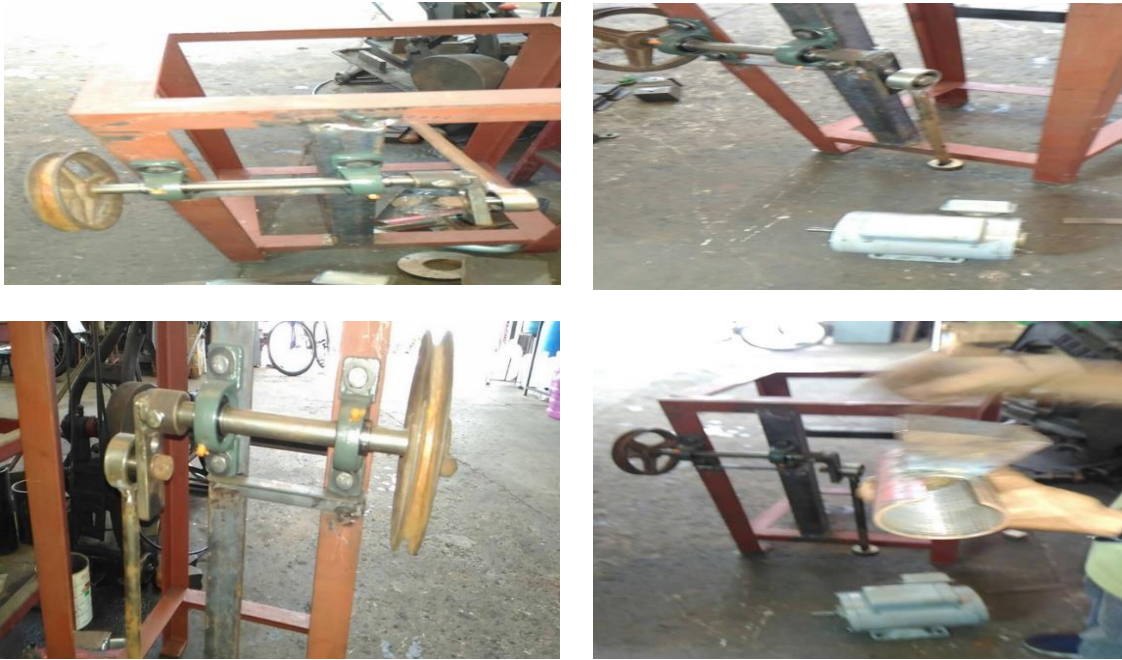
รูปที่ 10 ผลการพัฒนาเครื่องกะเทาะเปลือกหุ้มเนื้อในเมล็ดมะกึ่งเพื่อนำไปเป็นวัตถุดิบในการผลิตภัณฑอาหารชนิดต่างๆ
