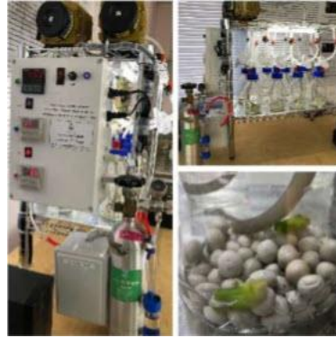
ชุดเพาะเลี้ยงเนื้อเยื่อพืชไบโอรีแอกเตอร์แบบจุ่มชั่วคราว
