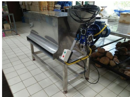
ภาพแสดง เครื่องแยกเนื้อมะเกี๋ยงที่พัฒนาขึ้นใหม่ ติดตั้งที่อาคารปฏิบัติการแปรรูปอาหาร
