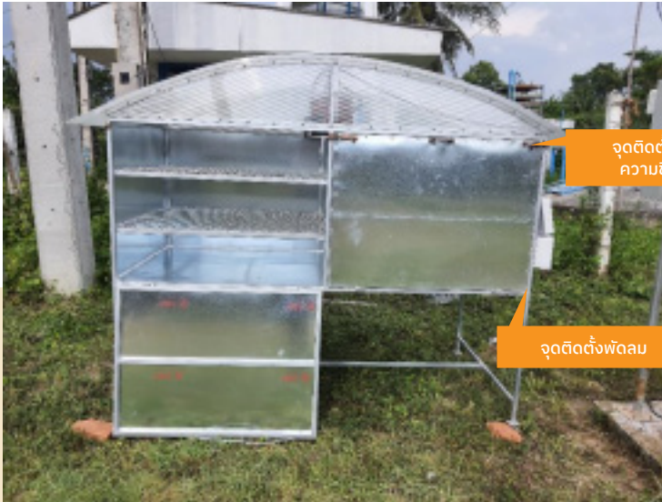
จุดติดตั้งพัดลมระบายอากาศและจุดวัดค่าอุณหภูมิ, ค่าความชื้น
