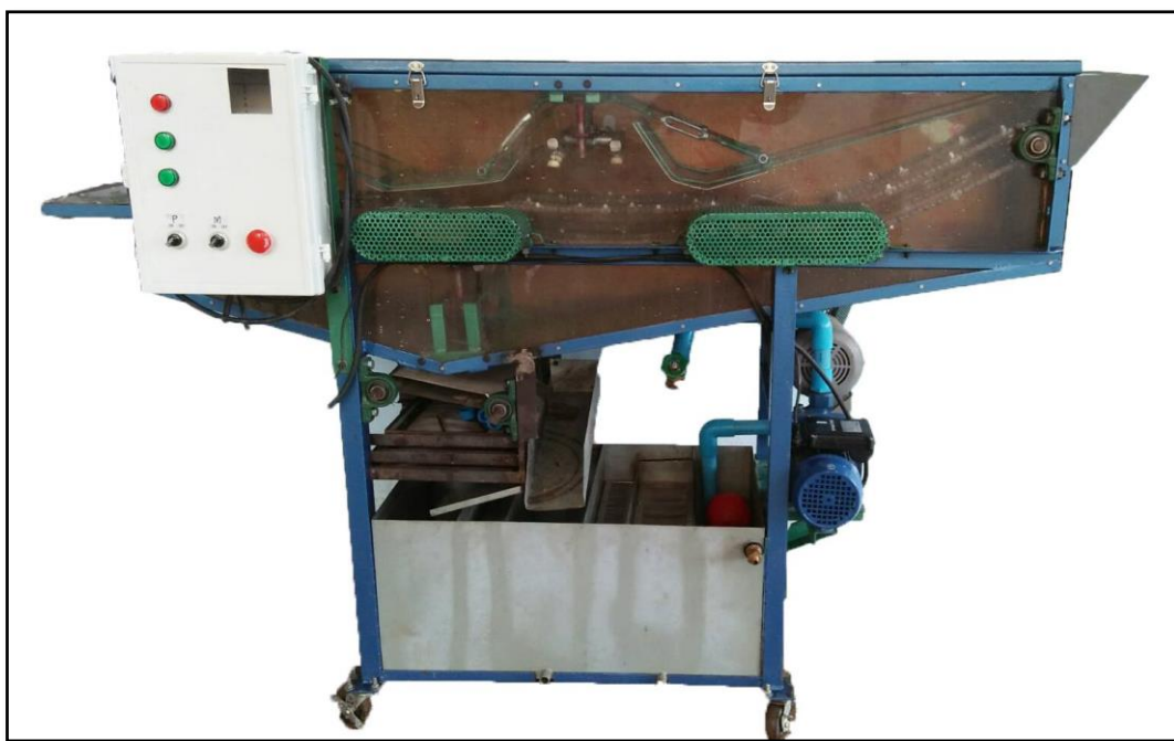
รูปที่ 3.37 เครื่องล้างถาดเพาะกล้าต้นข้าว
