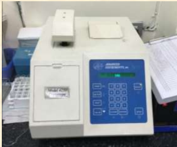
ภาพที่ 7 เครื่อง Cryoscope model 4250 ใช้ตรวจจุดเยือกแข็งในน้ำนม
