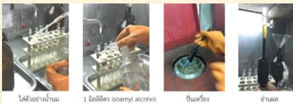
ภาพที่ 4 การวิเคราะห์ไขมันน้ำนมด้วยวิธี Gerber method
