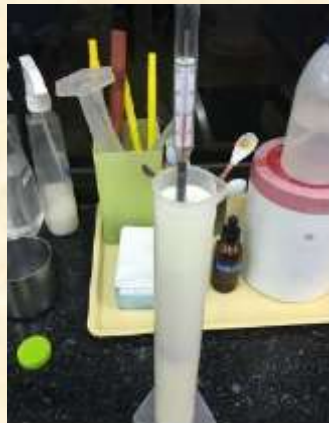
ภาพที่ 5 การวัดค่าความถ่วงจำเพาะโดยใช้ lactodensitometer หรือ lactometer
