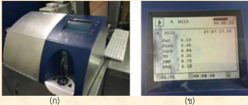
ภาพที่ 3 เครื่อง Milkoscan TM Minor สำหรับตรวจวิเคราะห์ส่วนประกอบน้ำนม (ก) และหน้าจอแสดงผลการวิเคราะห์ (ข)
